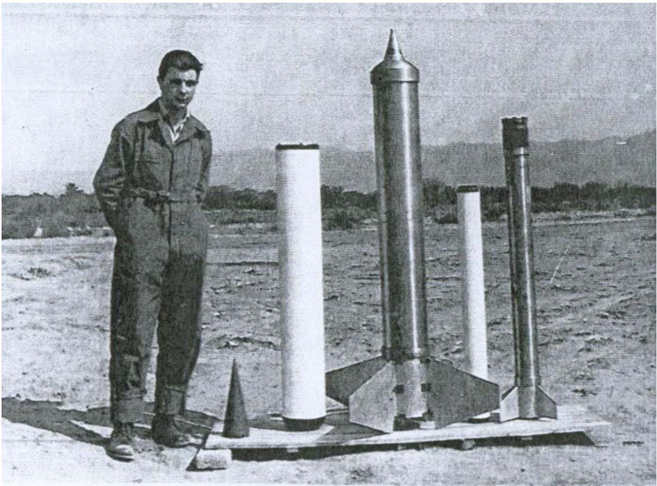
Foto N° 4 Granos y carcaza de los motores del PROSON M1
